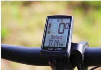
Das Sigma-Display zeigt die relevanten Fahrdaten an.
